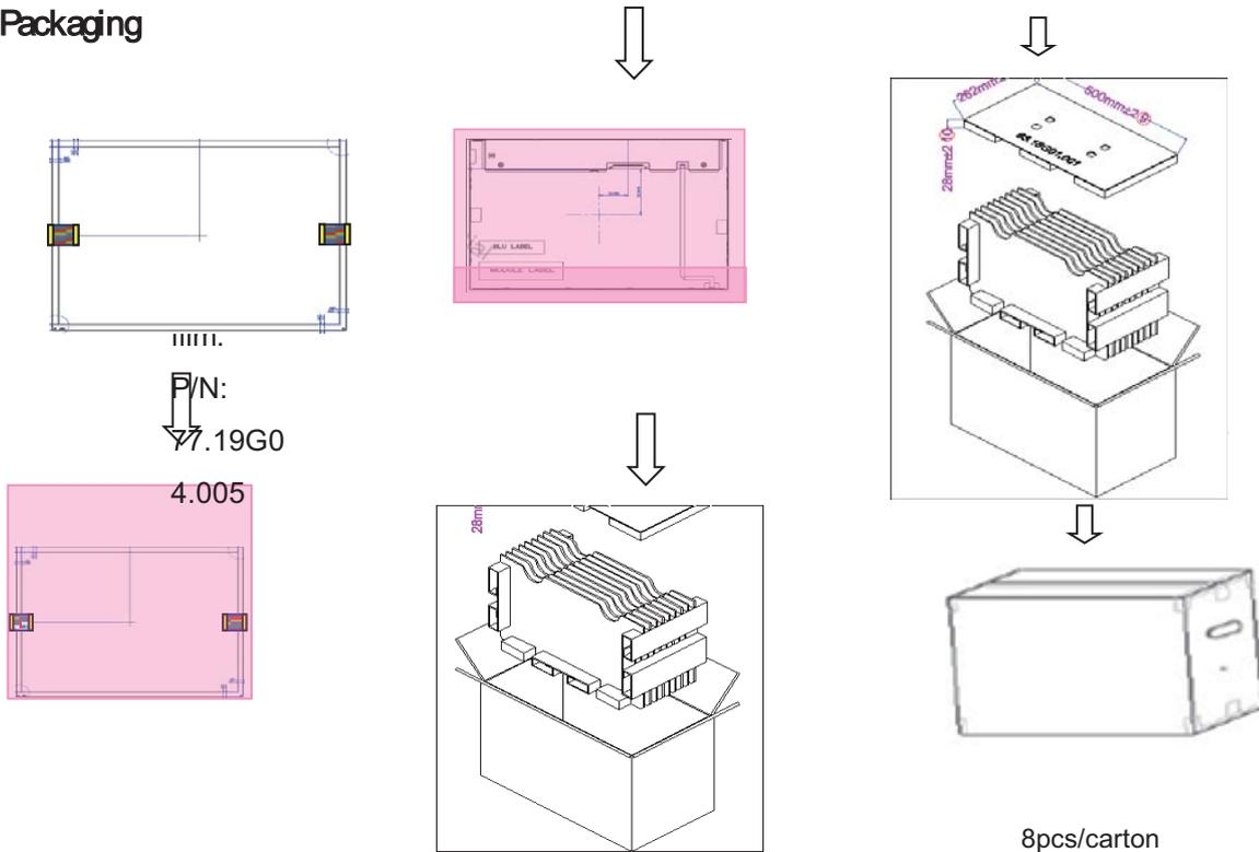
Max capacity: 8 TFT-LCD module per carton
